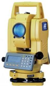
**Серия GPT-3100N** - это еще один шаг вперед в области выполнения безотражательных измерений при проведении съемочных и разбивочных работ. Приборы данной серии имеют двойную оптическую систему для работы в безотражательном режиме (узкий лазерный луч) и для измерений на призму (широкий лазерный луч).
