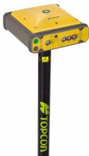
Высокоточная интегрированная одно-, двухчастотная ГЛОНАСС/GPS система геодезического класса для выполнения съемки в режимах статики, кинематики с постобработкой, RTK и DGPS. Приемник HiPer+ может использоваться для решения широкого спектра задач, таких как: создание и сгущение геодезических сетей, создание планово-высотного съемочного обоснования, выполнение картографических и кадастровых съемок, геодезическое сопровождение инженерных и строительных работ, выполнение других видов работ.
